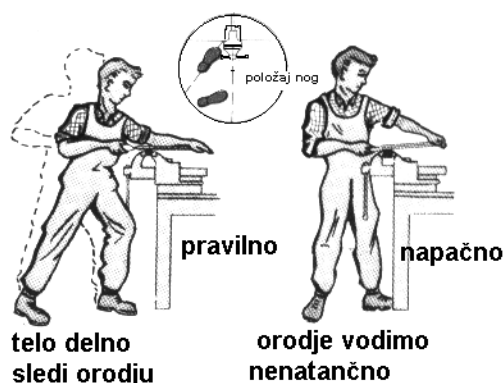
Slika 81: Položaj in gibanje telesa pri piljenju
