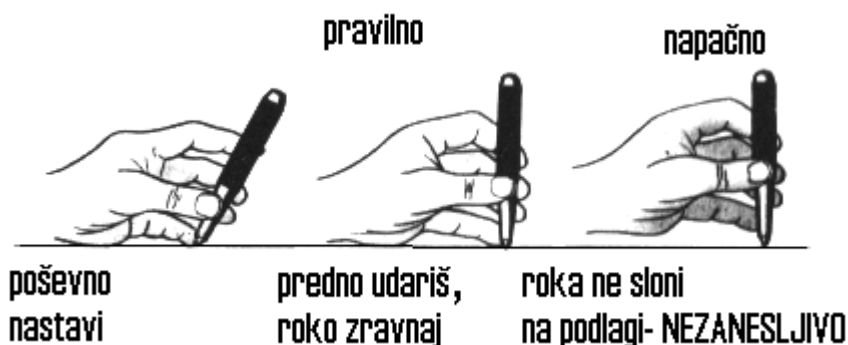
Slika 64: Točkanje v treh korakih: postavi, izravnaj, udari
