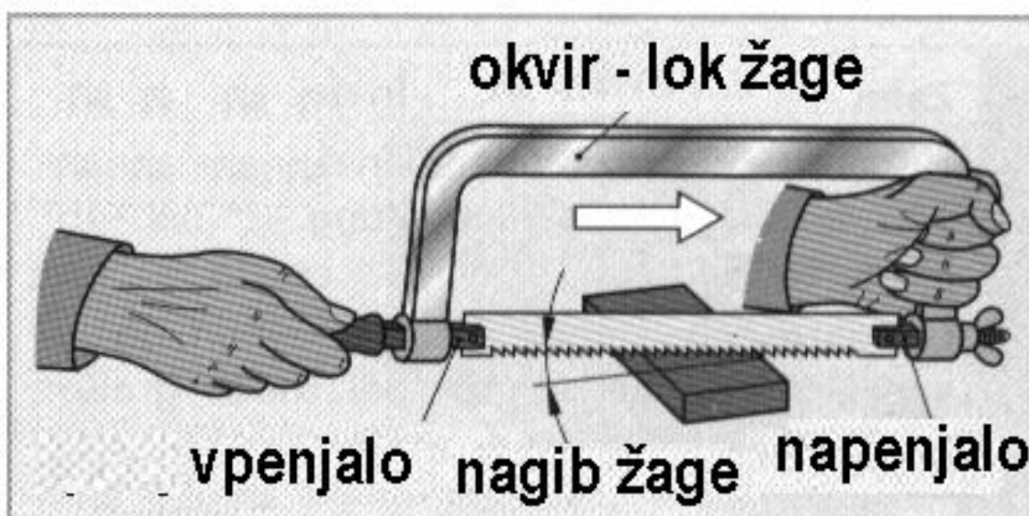
Slika 72: Postavitev orodja in obdelovanca pri žaganju.
